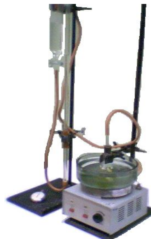
Реакционная установка для изучения кинетики разложения пероксида водорода
